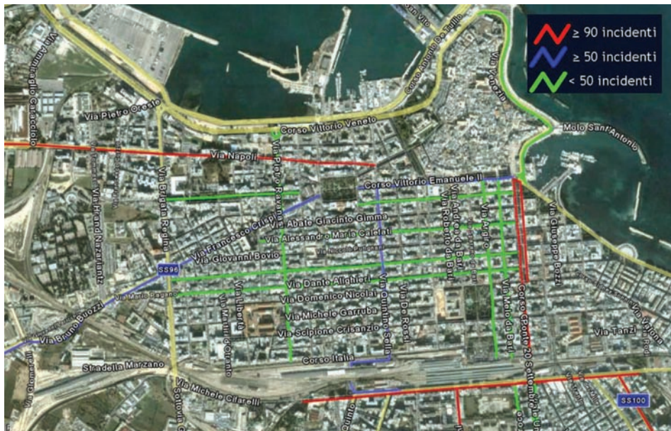
Fig. 4.10B - Georeferenziazione delle strade con il più alto numero di incidenti e localizzazione degli incroci pericolosi
