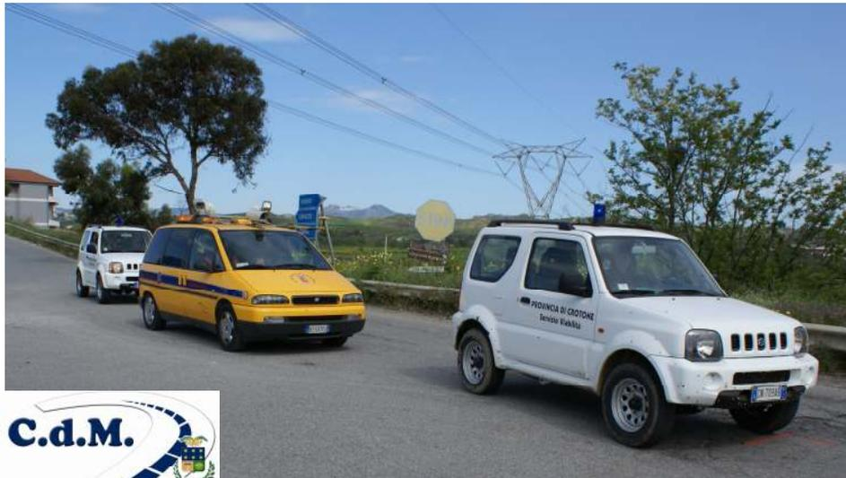
I rilievi video-foto-topografici sono eseguiti con uno speciale autoveicolo (Videocar) che in un unico passaggio acquisisce la geometria dell'asse stradale e le immagini fotografiche di tutto ciò che è visibile lungo la sede viaria.
